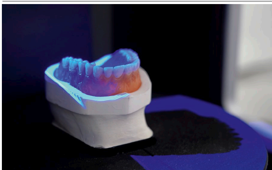
Scanvorgang Vollprothese ohne Spray
